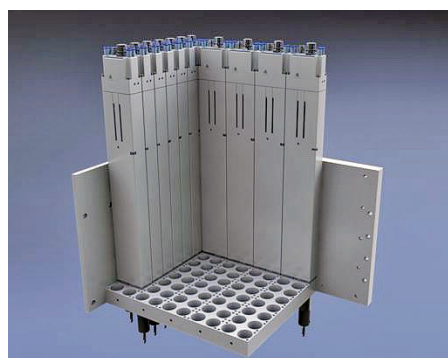
Bild 3: Mehrspindler-Kopf bestehend aus elf Bearbeitungsmodulen mit 60er Hub in L-Anordnung auf einem Matrix-Frame
