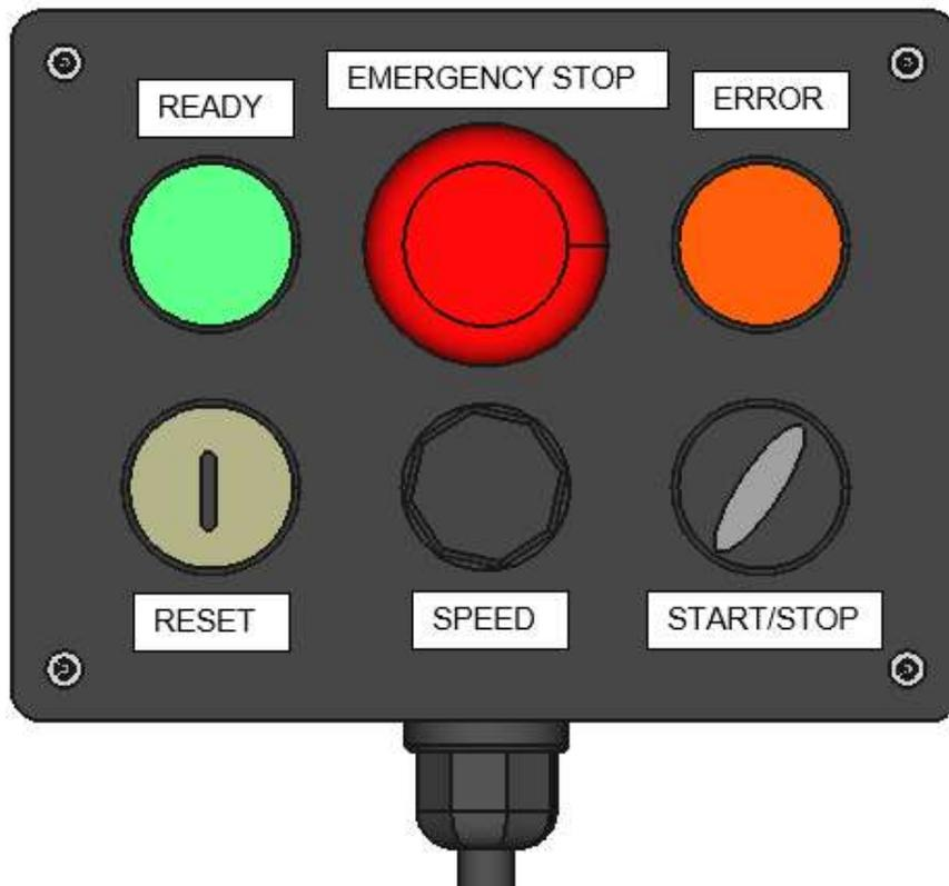
**EMERGENCY STOP:** Der Notaus wird mit einem kurzen Schlag auf den roten Knopf betätigt, die gelbe Fläche ist dann nicht mehr sichtbar. Der Regler SSC-SD-AGL zeigt Meldung „STOP“ und die Spindel dreht nicht. Die grüne Leuchte ist dennoch aktiv, da kein Fehler vorliegt. Der STO verhindert den weiteren Start. Für die Notaus Entfernung wird der Knopf etwas im Uhrzeigersinn gedreht und springt dann auf die geöffnete Position, so dass die gelbe Fläche wieder sichtbar ist.
